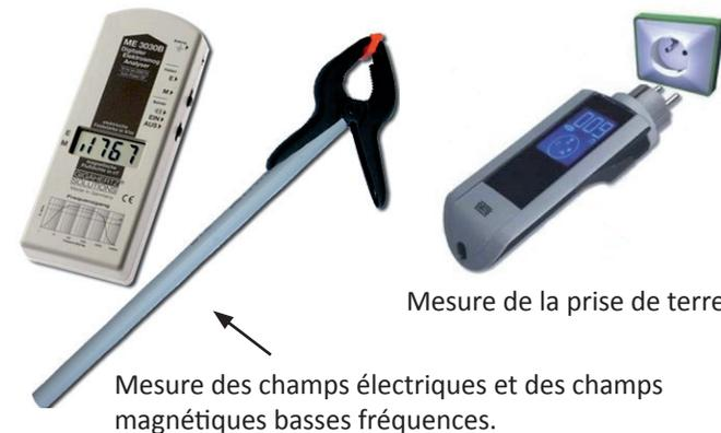
Mesure des champs électriques et des champs magnétiques basses fréquences.
